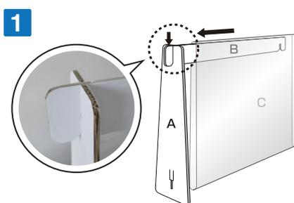
1 パーツ A の上部にパーツ B を取り付けます。ジョイント部分は、奥まではめ込みます。パーツ B に筒状のフィルム C を通します。
