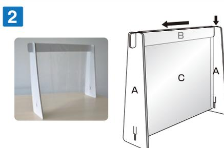
2 もう一枚のパーツ A の上部に、パーツ B を取り付けます。このとき、パーツ B を支えにフィルム C が垂れ下がった状態になります。
