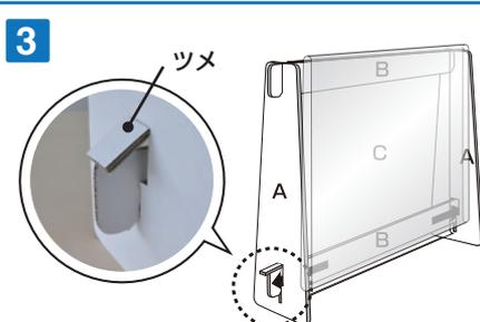
3 さらに、フィルム C に残りのパーツ B を通します。パーツ A 下部の差し込み口の「ツメ」を持ち上げて、パーツ B をはめ込みます。
